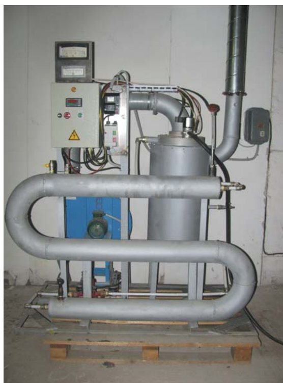
Рис. 3. Демонстратор котла с погружным нагревом воды с мощностью 50 кВт
